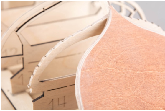
Fig.: Beveling the transom
