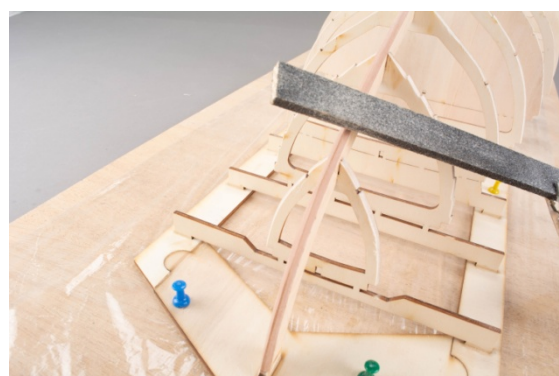
Fig.: Bevelling keel battens and frames
