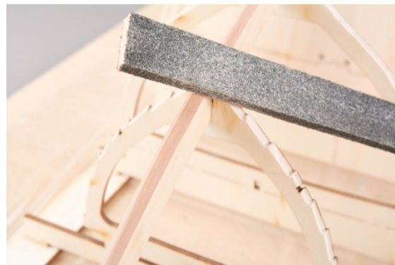
Fig.: Bevelling the frames
